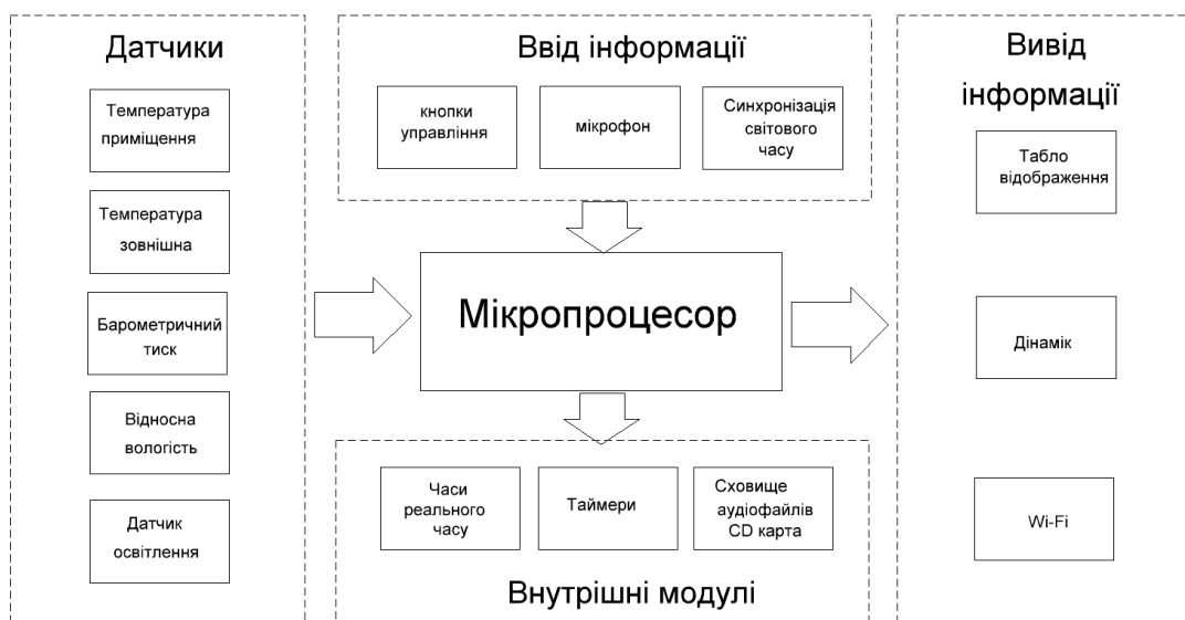
Рис. 6. Структурна схема функціоналу годинника
